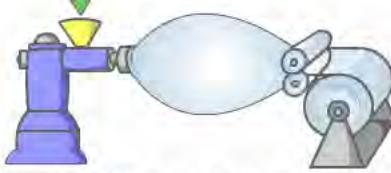
ポリ塩化ビニリデン(B)を加熱して溶かします。ふくらませてフィルム状にし、巻き取ります。
