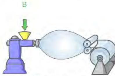
ポリ塩化ビニル(B)を加熱して溶かします。ふくらませてフィルム状にし、巻き取ります。
